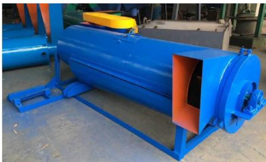
Gambar 2.3 Mesin Pengering Plastik
