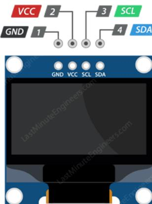
**Gambar 2.11** Konfigurasi pin OLED display
