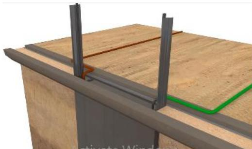
Gambar 5.35 Pemasangan Stop End
