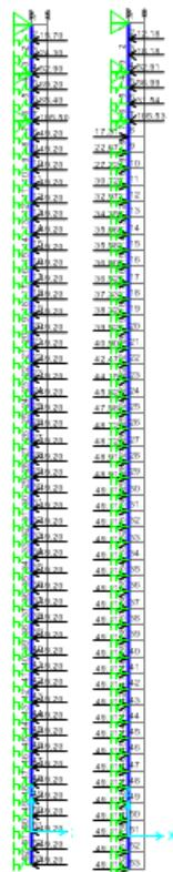
Gambar 5.7 Permodelan Tower 3 Pada SAP2000 Galian 2 dengan Pengaku (Iterasi I dan II) Top Down
