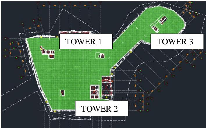
Gambar 6.13 Contoh Perhitungan Volume Pekerjaan Berbentuk Luas Pada Pekerjaan Plat Lantai Basement
