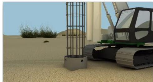
Gambar 5.39 Pemasangan *Casing* dan Tulangan
