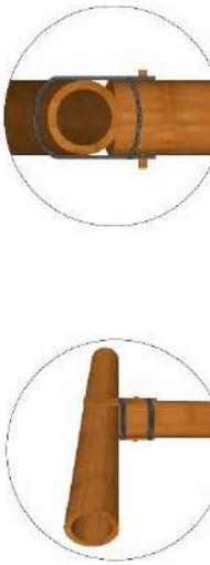
▷ Sambungan licah perdesai bambu yang mengikirin pergerakan elemen struktural secara horizontal. Pada jenis hubungan ini belum yang diaran hanya berupa bacak vertikal
