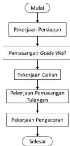
Gambar 7.1. Tahapan pekerjaan *diaphgram wall*
