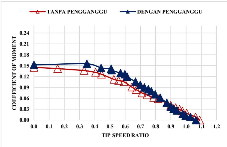
Gambar 4. 23 Grafik *Coefficient of Moment* Terhadap *Tip Speed Ratio* Turbin Angin Savonius Tanpa Silinder Pengganggu dan Dengan Silinder Pengganggu Pada Kecepatan 9 m/s
