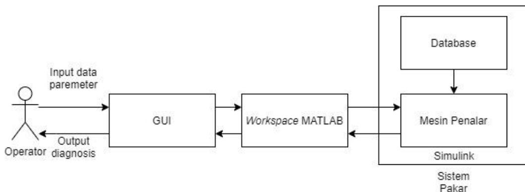
**Gambar 3.6** Skematic sistem pakar untuk diagnosis kondisi operasi *polishing unit*
