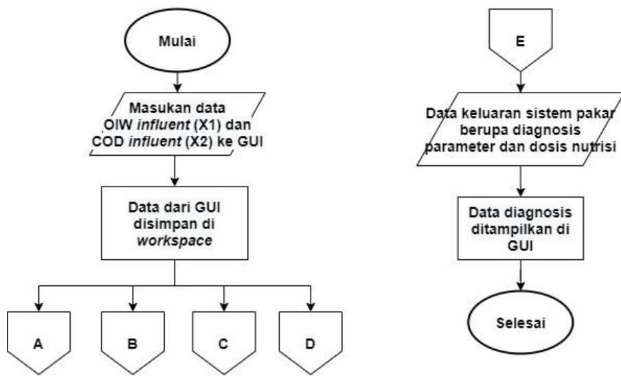
**Gambar 3.17** Diagram alir sistem pakar *polishing unit*
