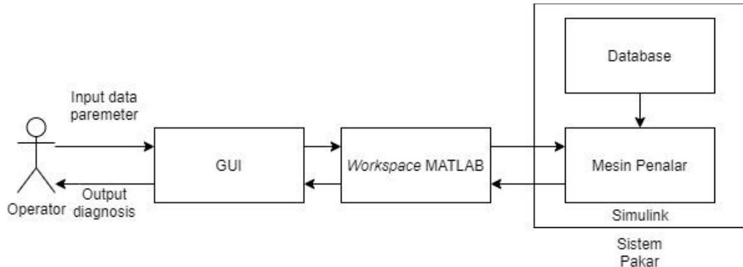
**Gambar 2.3** Skematik sistem pakar untuk diagnosis kondisi operasi *polishing unit*
