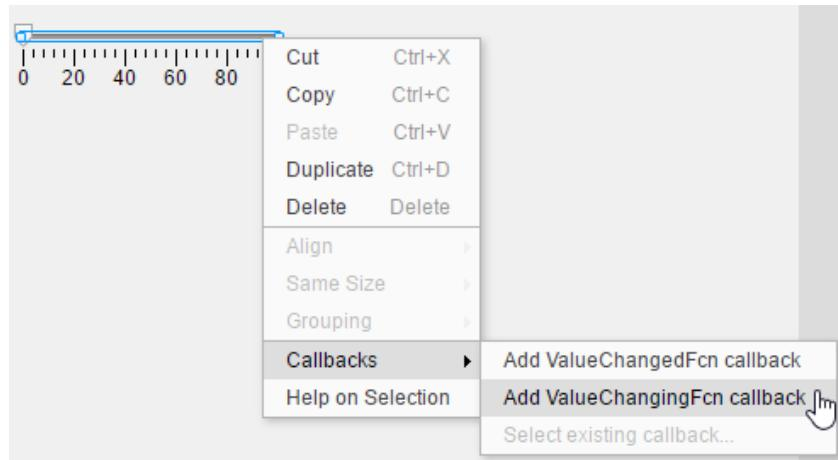
**Gambar 2.9** Contoh penambahan fungsi *callback* pada komponen GUI (The MathWorks, 2018)
