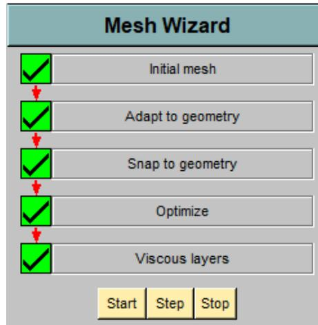
Gambar 4.4 Tahap Pembuatan *mesh* pada Numeca FineMarine
