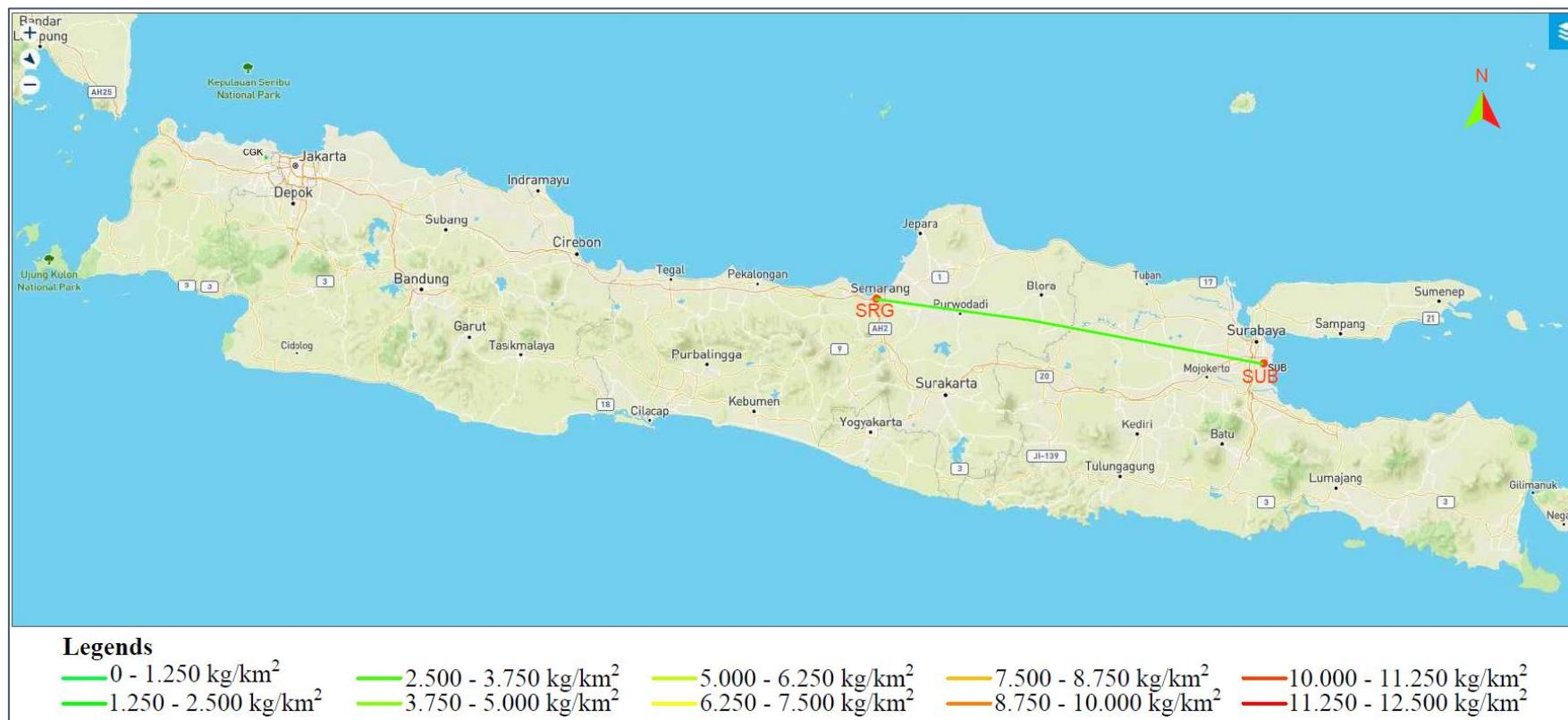
Gambar 4.69 Bentuk peta sebaran emisi gas CO<sub>2</sub> dengan upaya pengurangan emisi skenario 2 tahun 2030 pada rute SRG - SUB.
