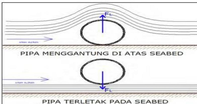
**Gambar 2.4** Ilustrasi Konsentrasi Streamline yang Melewati Pipa (Pratama, 2007)
