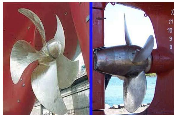
Gambar 1. 1 Contoh *propeller* FPP dan CPP pada kapal
