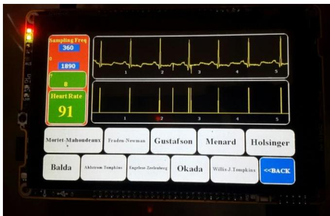
**Gambar 4.4** Interface Mikrokontroler saat simulasi metode “Fraden and Neuman” yang dipilih.
