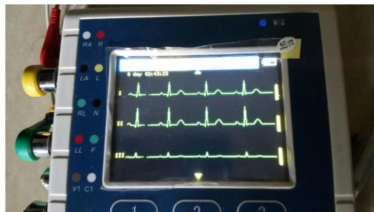
**Gambar 4.14** Sinyal output yang disimulasikan oleh phantom ECG dengan *heart rate* sebesar 80 bpm.
