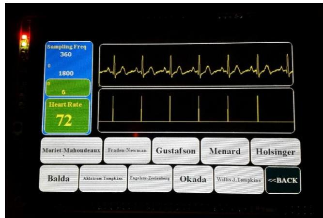
**Gambar 4.15** Interface Mikrokontroler saat melakukan pengukuran pada metode “Moriet-Mahoudeau” yang dipilih dengan input 80 bpm.
