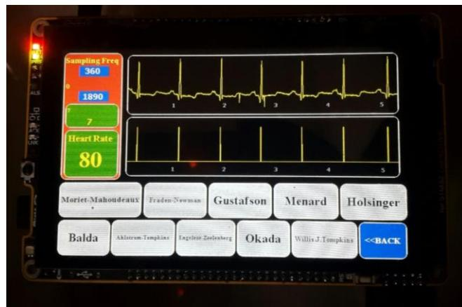
**Gambar 4.5** Interface Mikrokontroler saat simulasi metode “Gustafson” yang dipilih.
