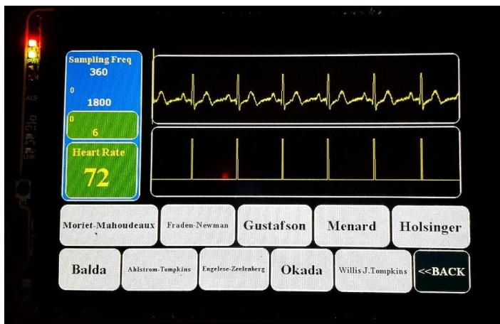
**Gambar 4.22** Interface Mikrokontroler saat melakukan pengukuran pada metode “Engelese and Zeelenberg” yang dipilih dengan input 80 bpm.
