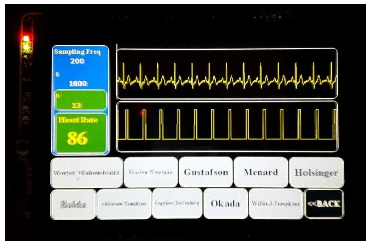
**Gambar 4.24** Interface Mikrokontroler saat melakukan pengukuran pada metode “Pan and Tompkins” yang dipilih dengan input 80 bpm.
