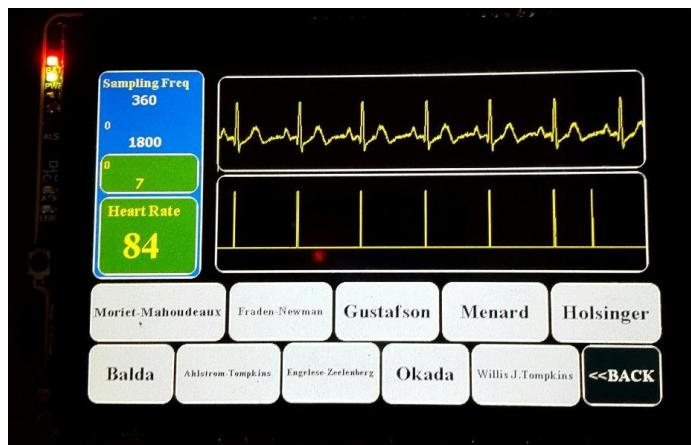
**Gambar 4.19** Interface Mikrokontroler saat melakukan pengukuran pada metode “Holsinger” yang dipilih dengan input 80 bpm.
