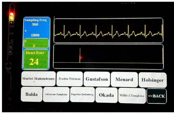
**Gambar 4.21** Interface Mikrokontroler saat melakukan pengukuran pada metode “Ahlstrom and Tompkins” yang dipilih dengan input 80 bpm.
