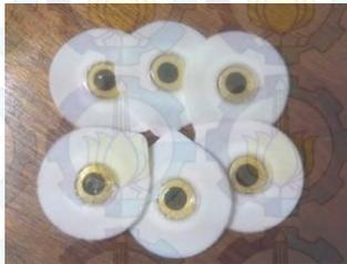
Gambar 2.7 Sensor Elektroda
