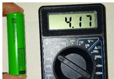
Gambar 4.15 Pengukuran tegangan baterai menggunakan avometer digital
