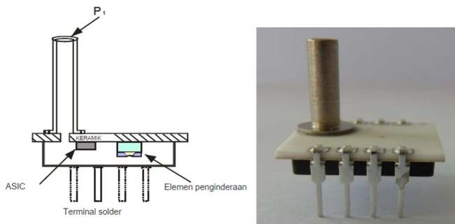
Gambar 2.7 Sensor tekanan absolut, menggunakan AMS 5812 sebagai contoh
