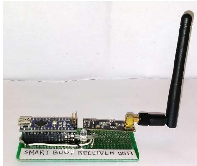
Gambar 4.8 Perangkat Penerima (*Smart Buoy Server*)
