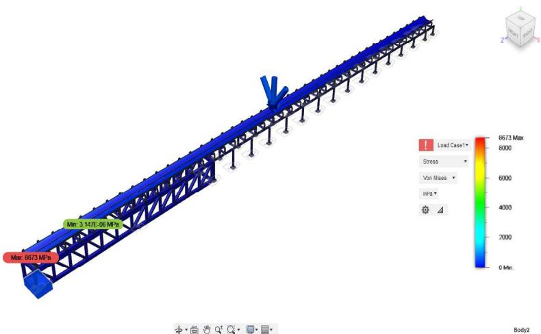
**Gambar 4.5.7** Permodelan Desain Conveyor B-1 dan B-2 (Part 2, Bidang Lurus)
