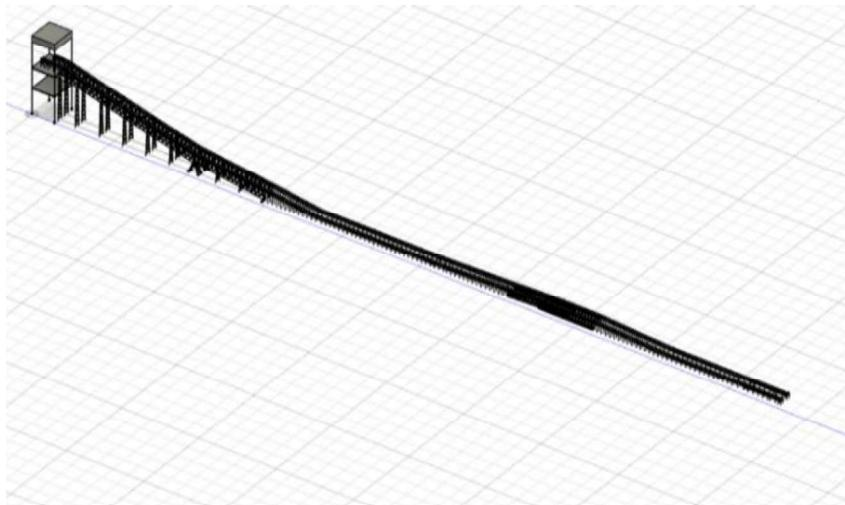
**Gambar 4.12** Permodelan 3D Conveyor B-1 dan B-2
