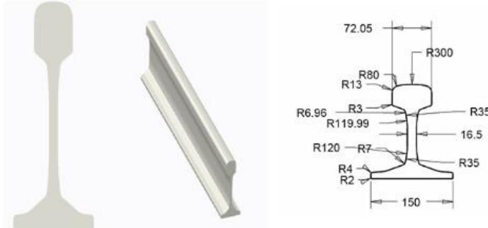
Gambar 2. 13 Spesifikasi rel UIC 60kg/m (Singh, 2016)
