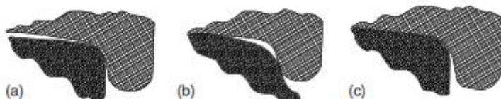
Gambar 2. 25 Posisi kontak yang memungkinkan antara roda dengan rel: (a) *single-point contact*; (b) *two-point contact*; (c) *conformal contact* (Redtenbacher, 1855)
