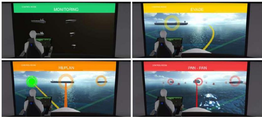
Gambar 4.2 Ilustrasi Mode Operasi dari Pusat Kendali
