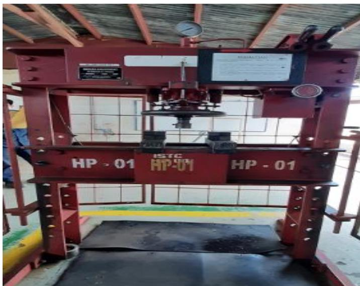
**Gambar 5.2 Mesin Prese Hidrolik**
