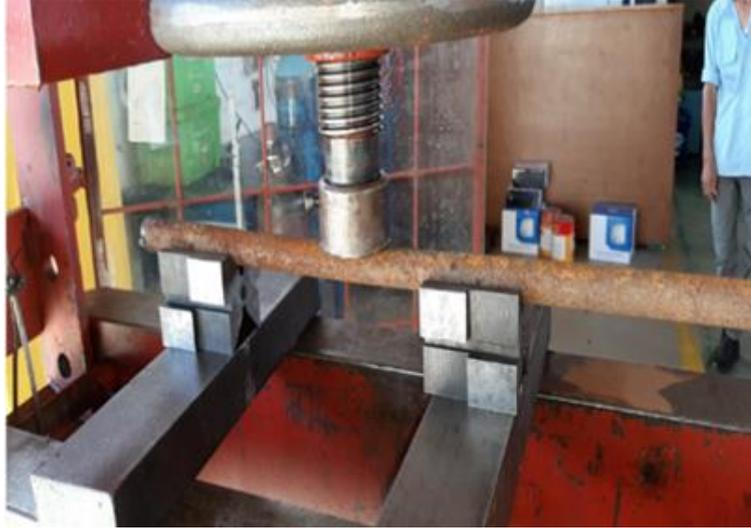
**Gambar 5.5 Proses meluruskan dengan mesin press**
