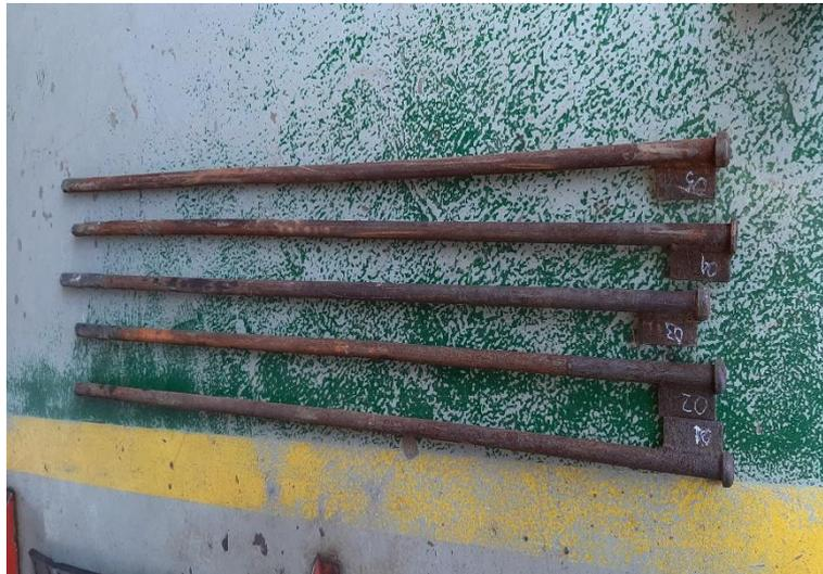
**Gambar 5.7 Hasil *puncher bar* telah dipress**
