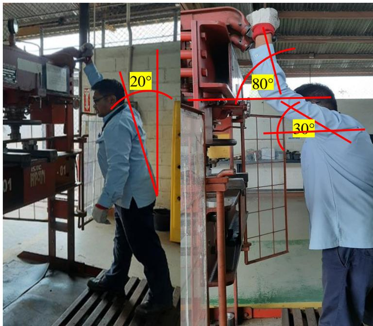
**Gambar 5.9 Penilaian Postur kerja meluruskan pada mesin press hidrolik**
