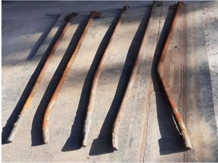
**Gambar 5.1 Puncher bar yang akan diluruskan**
