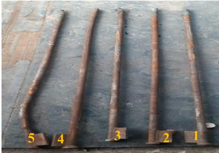
**Gambar 4.1 Bentuk *puncher bar* yang akan diluruskan**
