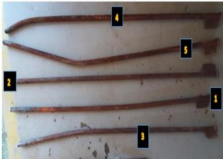
**Gambar 5.6 Puncher bar yang akan diluruskan**
