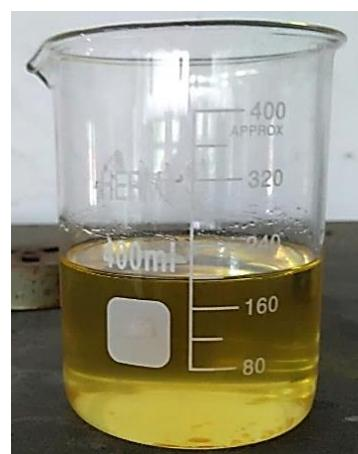
Gambar 4.3 Biodiesel minyak jelantah
