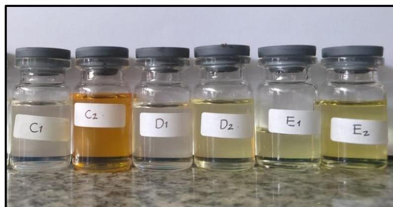
Gambar 4.16 Produk hidrokarbon cair hasil ko-perengkahan katalitik minyak PS dengan biodiesel minyak kemiri (*Aleurites moluccana*)
