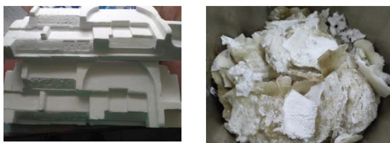
Gambar 4.6 (a) Limbah polistirena berupa EPS. (b) Lempengan polistirena hasil proses pemampatan.
