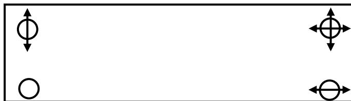
Gambar 3.4 Model Perletakan jembatan
