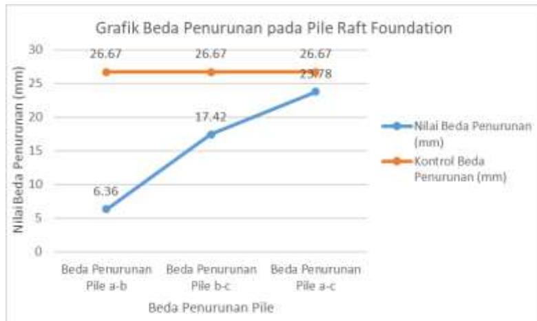
**Gambar 5. 21.** Grafik Beda Penuurunan pada Pile
