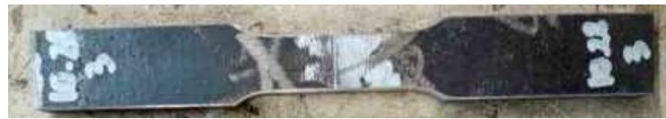
Gambar 3.20 Benda uji *tensile test*
