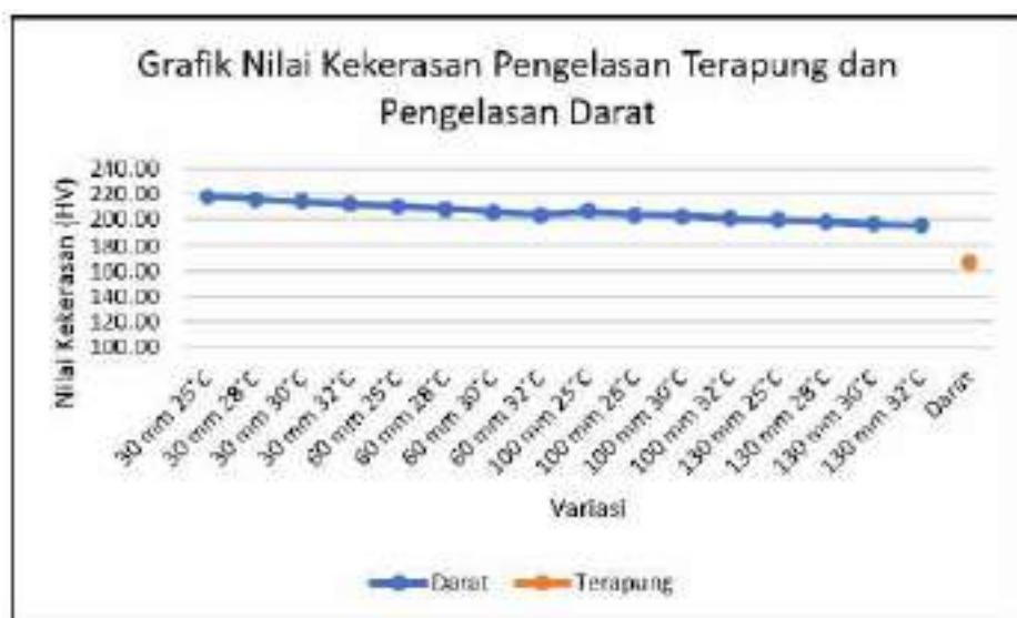
Gambar 4.23 Grafik nilai kekerasan pengelasan di atas permukaan air dan pengelasan darat
