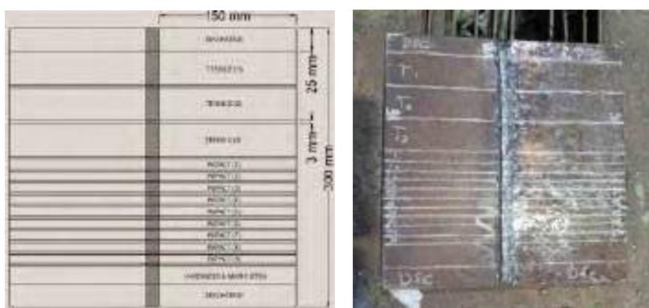
Gambar 3.15 (a) Ilustrasi dan (b) Perencanaan pemotongan *work piece* untuk dijadikan benda uji
