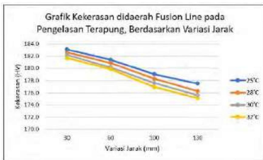
Gambar 4.19 Grafik kekerasan di daerah *fusion line* pada pengelasan di atas permukaan air berdasarkan variasi jarak
