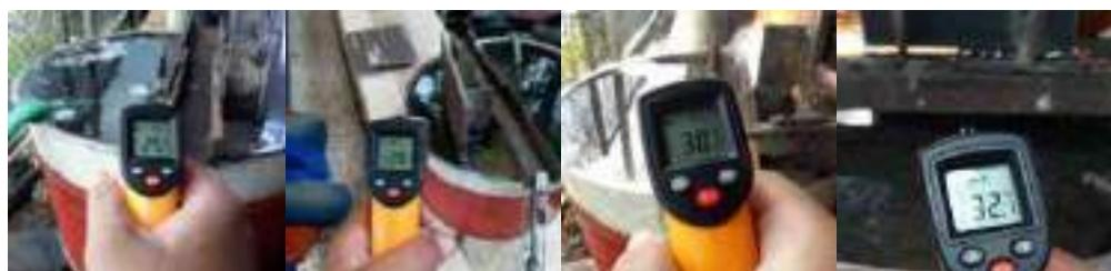
Gambar 3.11 Variasi temperatur air, (a)  $25^{\circ}\text{C}$ , (b)  $28^{\circ}\text{C}$ , (c)  $30^{\circ}\text{C}$ , (d)  $32^{\circ}\text{C}$
