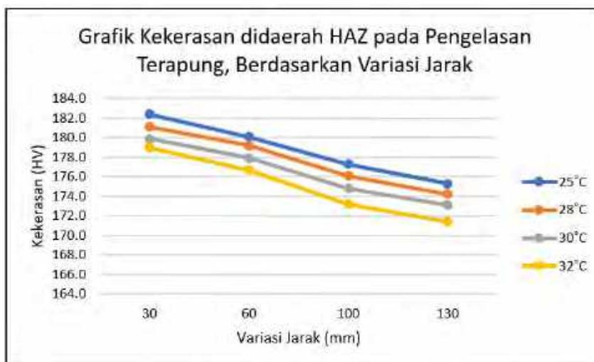
Gambar 4.17 Grafik kekerasan di daerah HAZ pada pengelasan di atas permukaan air berdasarkan variasi jarak
