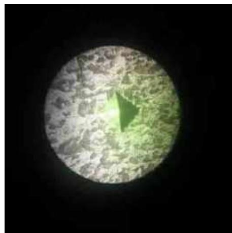
Gambar 3.27 Hasil penetrasi dilihat dari mikroskop
