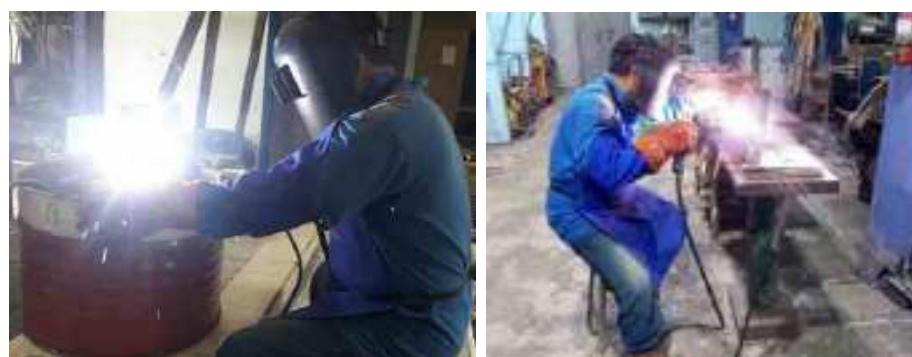
Gambar 3.14 Proses pengelasan, (a) Di atas permukaan air, (b) Di darat
