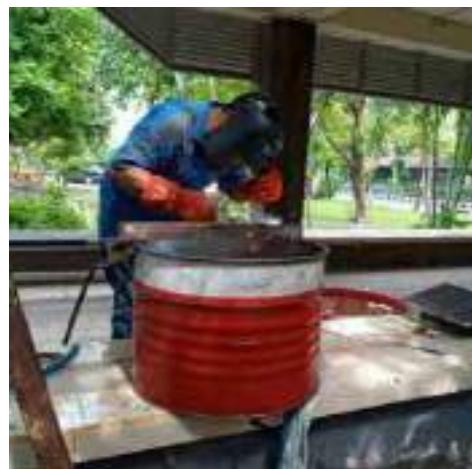
Gambar 3.12 Pemasangan pelat melintang pada bak air
