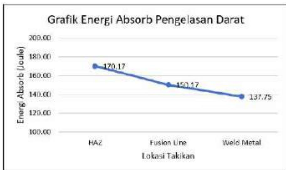
Gambar 4.28 Grafik nilai energi *absorb* pada pengelasan di darat
