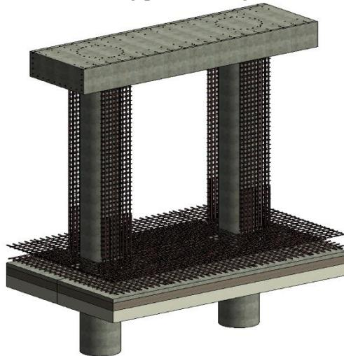
Gambar 6. 3 3D tulangan bottom slab & dinding tengah
