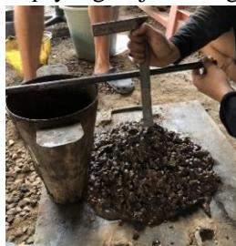
Gambar 3.18 Pengujian *Slump*
