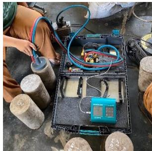
**Gambar 3.22 Pengujian Permeability**
