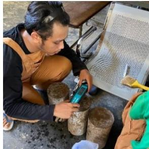
**Gambar 3.20 Pengujian Resistivity**
