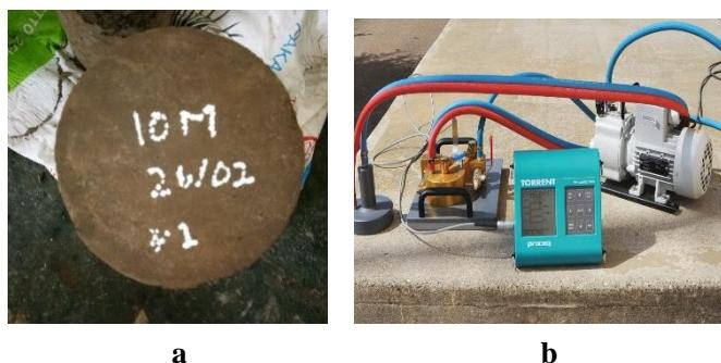
**Gambar 3.29** (a) Benda uji (b) Alat uji *Permeability*
