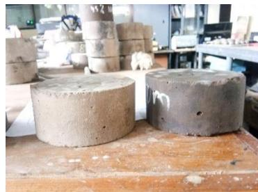
**Gambar 3.39** Kondisi Sampel setelah di oven (kiri)
