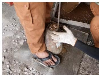
**Gambar 3.21** Memasukkan Adonan Beton ke dalam Kerucut Slump
