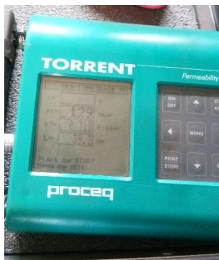
**Gambar 3.33** Output dari Permeability Test
