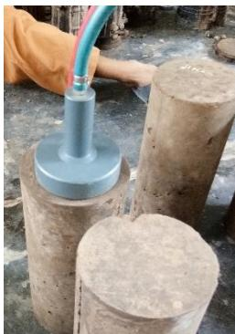
**Gambar 3.31** Meletakkan vakum di atas permukaan beton yang rata
