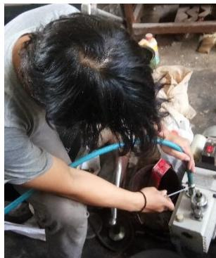
**Gambar 3.30** Memasang selang vakum ke pompa
