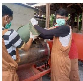
**Gambar 3.13** Memasukkan Material Semen Geopolimer ke dalam Mesin Grinding
