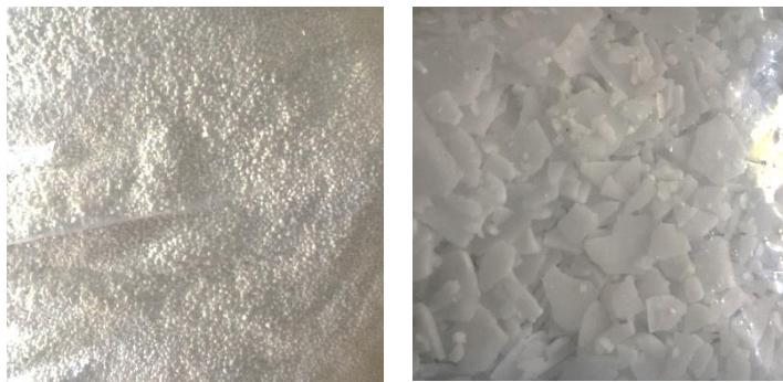
**Gambar 2.10** Alkali Aktivator; (a) Sodium Silikat (b) Sodium Hidroksida
