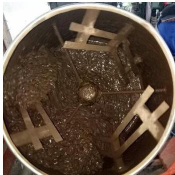
**Gambar 3.20** Adonan Beton Tercampur Rata dan Homogen
