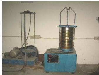
**Gambar 3.5 Saringan Agregat dan Sieve Shacker**
