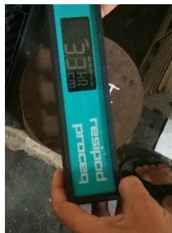
**Gambar 3.28** Menekan alat Resipod Proceq ke benda uji
