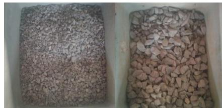
Gambar 2.2.1.1 Agregat 5-10mm (kiri), Agregat 10-10mm (kanan)
