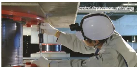
Gambar 9. 20 Pengecekan Perpindahan Vertikal
