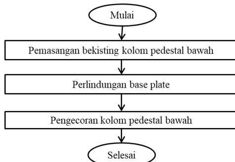
Gambar 9. 6 Diagram Alir Pengecoran Kolom Pendestal
