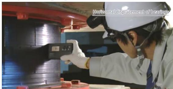
Gambar 9. 19 Pengecekan Perpindahan Horizontal
