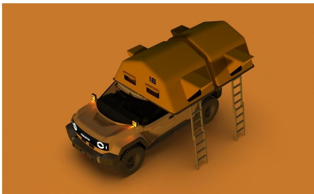
Gambar 5. 19. *Roof Bar* dengan *Roof-top Tent* (GEOWISATA)
