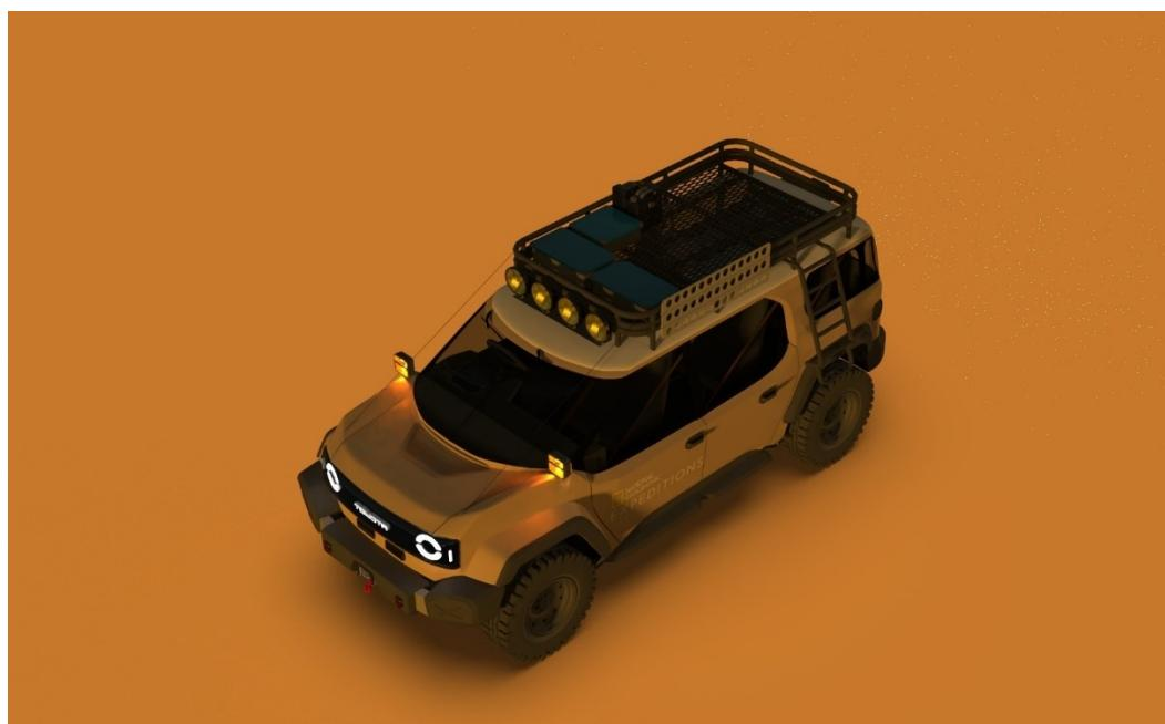
Gambar 5. 20. *Roof Rack* dengan *Side Ladder* (GEOWISATA)
