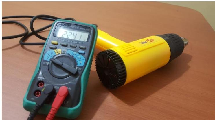
**Gambar 4.7** Pengambilan Data Sensor Tegangan pada *Heat Gun*
