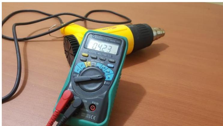
**Gambar 4.8** Pengambilan Data Sensor Arus pada *Heat Gun*
