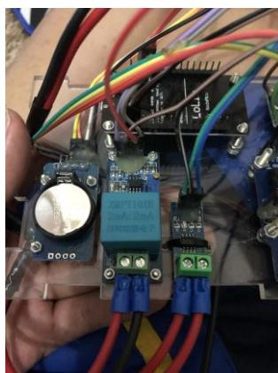
**Gambar 3.4** Tampilan rangkaian sensor Tegangan
