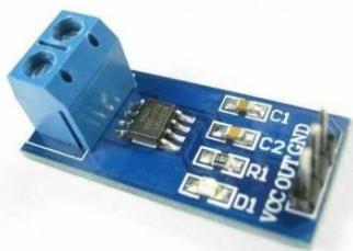
**Gambar 2.6** Modul Sensor Arus ACS712
