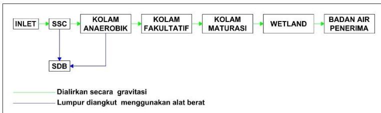
**Gambar 5. 1 Diagram Alir Proses Eksisting IPLT Betoyoguci**
