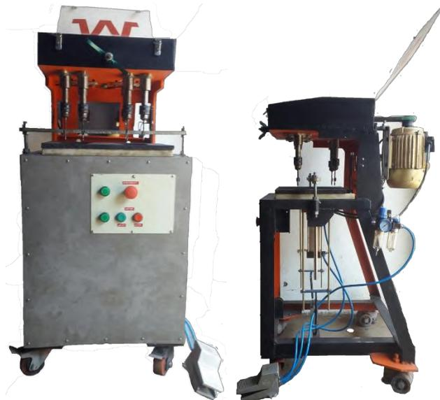
Gambar 4.13 Foto Mesin Bor Sandal Sistem Pneumatik
