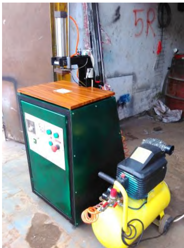
Gambar 3.4 Mesin Hot embossing Kertas dengan Sistem Elektro-Pneumatik
