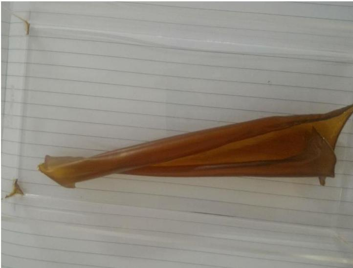
Gambar 4. 5 Membran Komposit Kitosan/MMT-Glutaraldehyd
