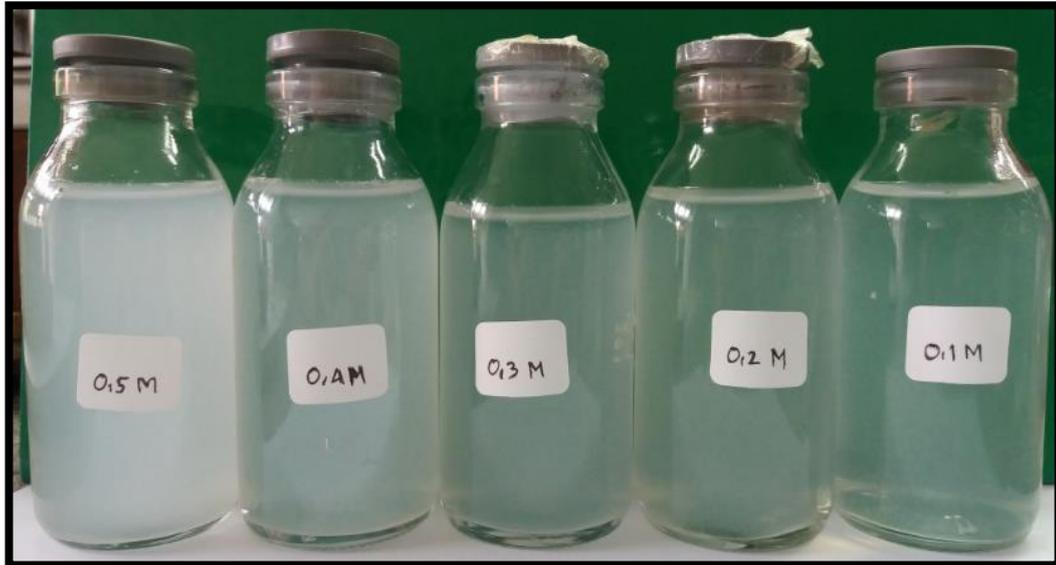
**Gambar 4.2.** Perubahan warna Larutan pada proses sintesis alumina Nanopartikel menggunakan variasi konsentrasi NaCl 0,1 M; 0,2 M; 0,3 M; 0,4 M dan 0,5 M pada potensial 50 Volt.
