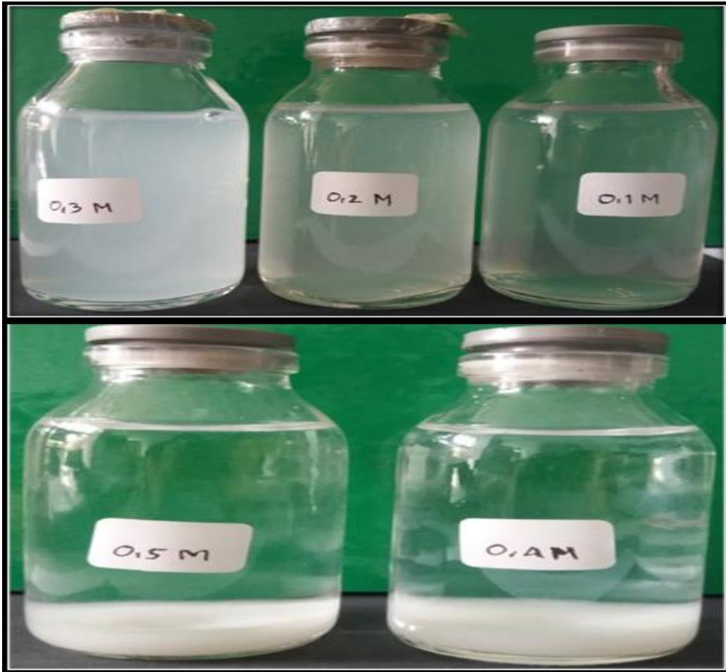
**Gambar 4.4.** Kondisi larutan alumina nanopartikel setelah terjadi pengendapan .
