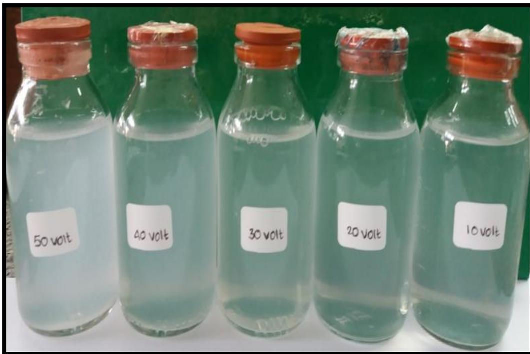
**Gambar 4.7** Perubahan warna larutan pada proses sintesis nanopartikel aluminium oksida menggunakan variasi konsentrasi NaCl 0,1 M; 0,2 M; 0,3 M; 0,4 M Dan 0,5 M pada potensial 50 Volt.
