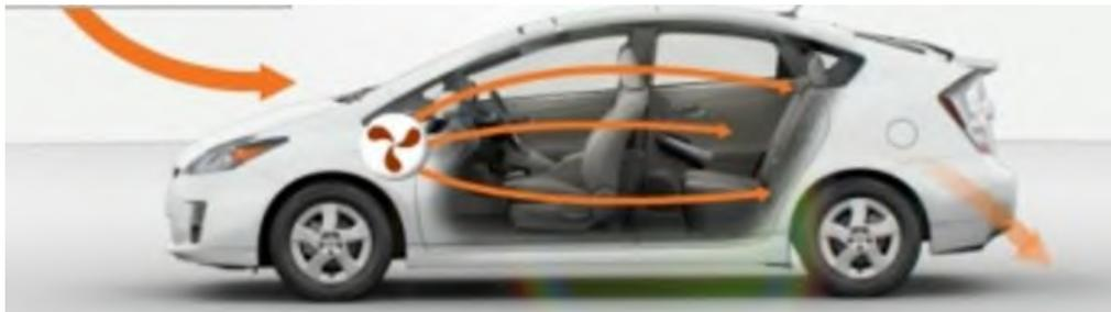
Gambar 46. Mekanisme aliran udara dalam interior mobil
