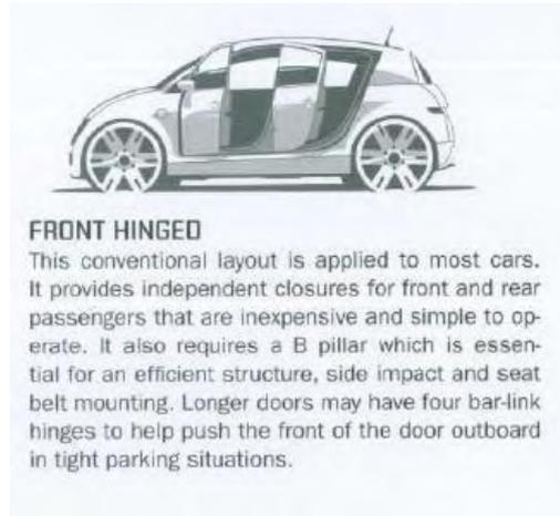
Gambar 30. Mekanisme pintu engsel depan (front hinged). Sumber: H-Point
