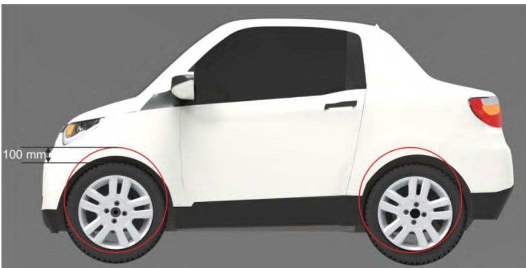
Gambar 25. Tires packing pada desain
