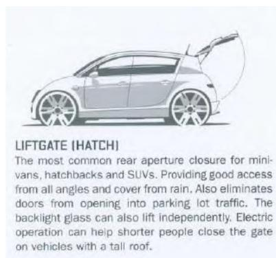
Gambar 33. Mekanisme pintu liftgate pada bagasi. Sumber: H-Point
