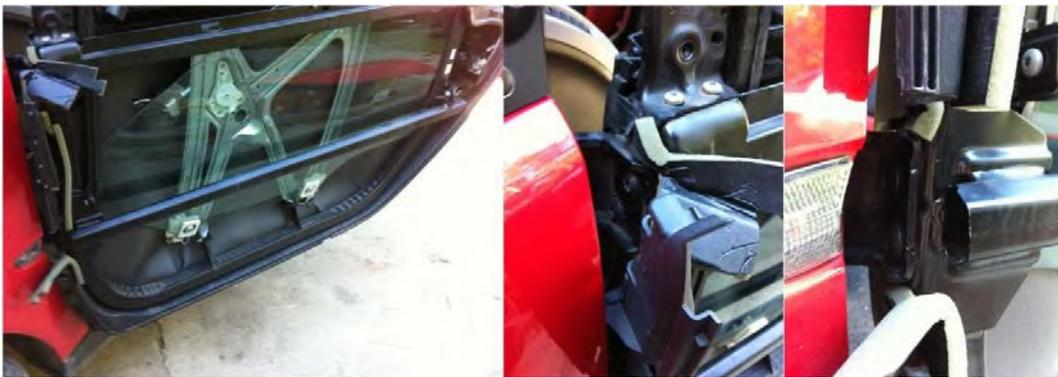
Gambar 31. Mekanisme pintu beserta engsel dari Smart Fortwo
