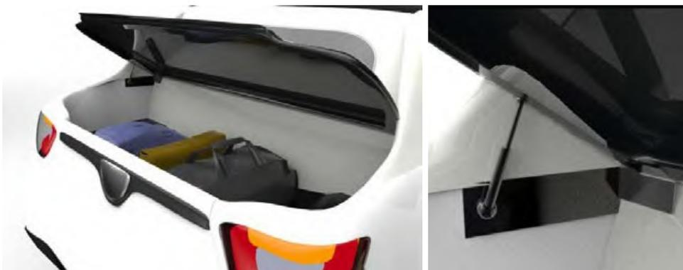
Gambar 35. Pengaplikasian engsel dan hidrolik pada bagasi
