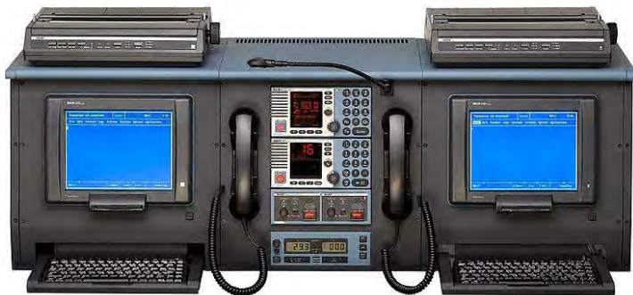
Gambar 2.4 Sailor GMDSS A3 Station dengan Telex ( http://commons.wikimedia.org/wiki/File:SAILOR_GMDSS_A3.jp g)
