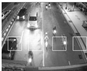
**Gambar 4.19:** Lampu sorot kendaraan yang mengenai permukaan jalan
