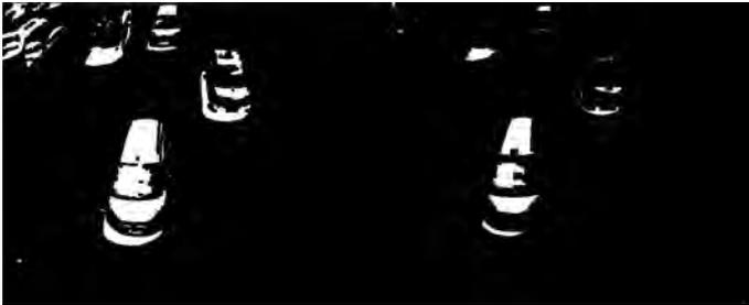
**Gambar 3.9:** Citra hasil *erosi*. Gambar kiri merupakan hasil erosi 1 kali. Gambar kanan adalah hasil erosi 2 kali
