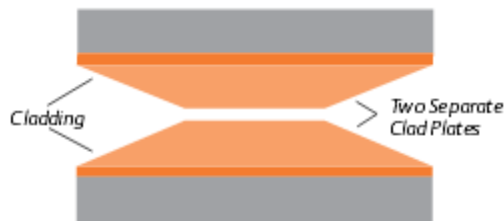
Gambar 2.15. Hasil dari hot roll bonding [ http://www.arcelormittalna.com ]
