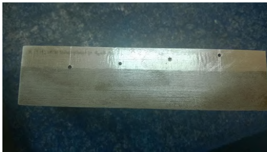
Gambar 3.4. Side drill hole pada blok BCB teknik 1
