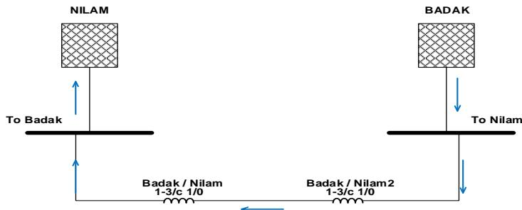
**Gambar 3.1** Single line diagram sistem kelistrikan PT. VICO Indonesia
