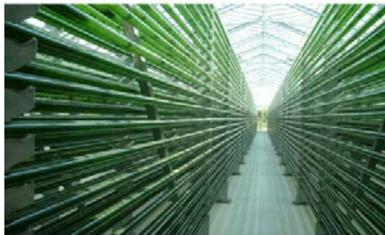
**Gambar 2.6** *Tubular Photobioreactor*(Vonshak dan Torzillo, 2004)
