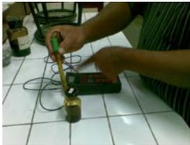
**Gambar 4.1** Validasi alat ukur pH
