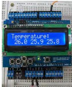
**Gambar 3.19** Hasil pengujian sistem *monitoring* temperatur pada rangkaian *hardware*
