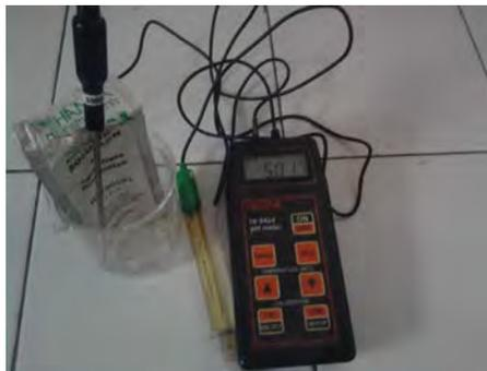
**Gambar 3.14** Perlengkapan untuk *monitoring* Ph
