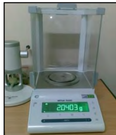
Gambar 3.8 Penimbangan Sampel Menggunakan Timbangan Mettler Toledo MS104S
