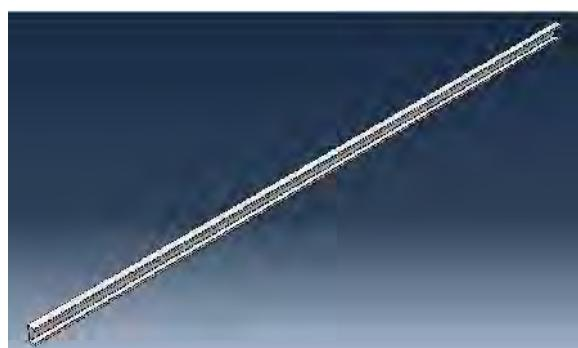
Gambar 3.11 Penampang balok *light lip channel* yang akan di gabungkan dengan penampang silinder.
