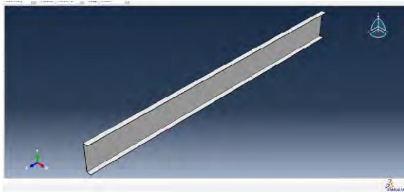
Gambar 6.22. Penampang Balok baja canai dingin LC 300.50.50.4,5
