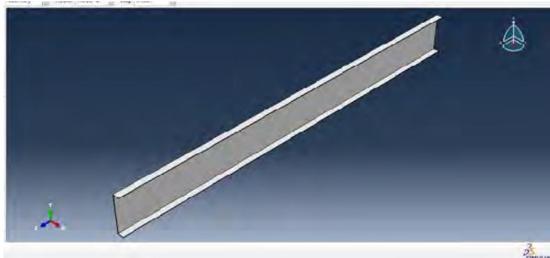
Gambar 6.2. Penampang Balok baja canai dingin LC 300.50.50.4.
