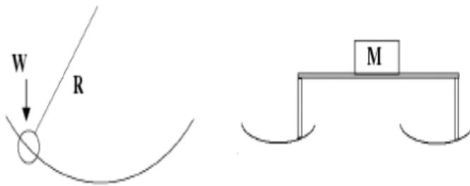
**Gambar 2.7** Konsep Perpindahan FPS Seperti Pendulum
