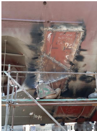
Proses Pengelasan Setelah Replating
