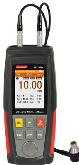
Gambar 5.7 Alat untuk Ultrasonic Test (Sumber : Alatproyek.com)
