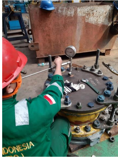
Proses Pengujian Katup dengan Tekanan Fluida Liquid (Pressure Test)
