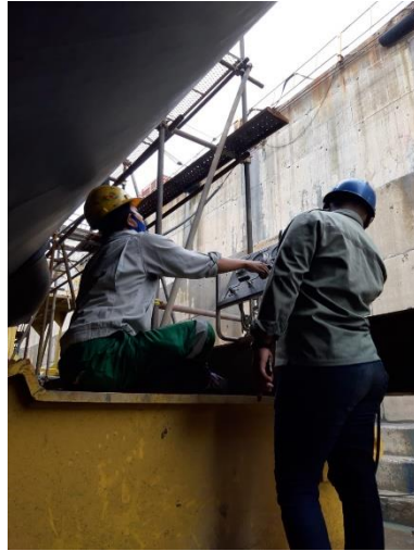
Verifikasi Pressure Test valve (hydro test) KRI Alugoro (Kapal Selam)
