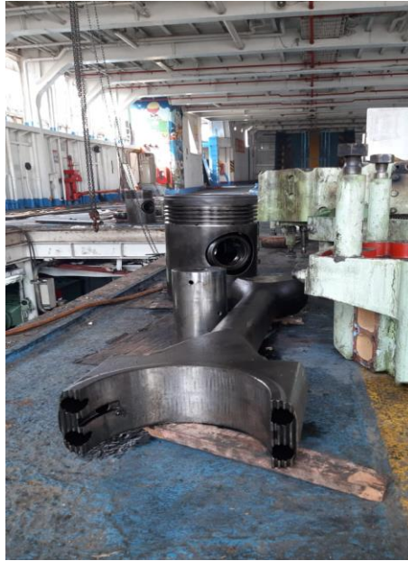
Overhaul mesin penggerak pokok kapal KM SATYA KENCANA II
