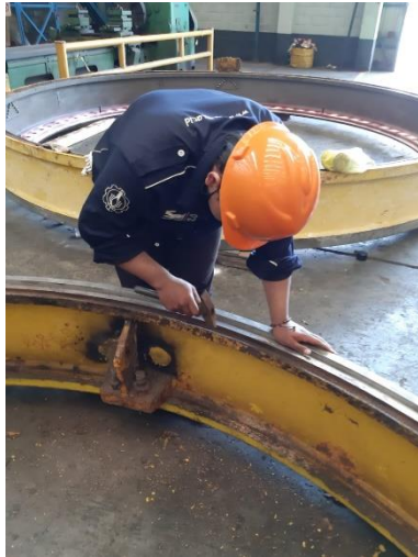
Pembersihan karat pada Mean Ring Bearing (MRB)
