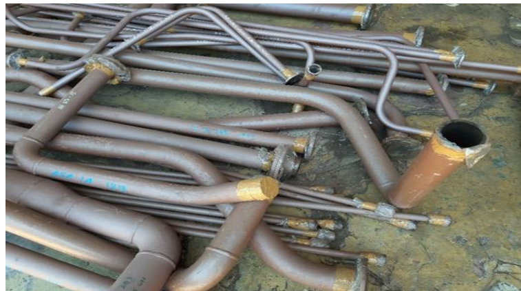
Pipa Setelah dilakukan Pickling
