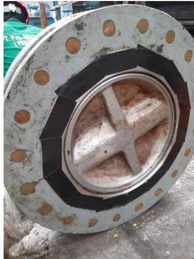
Menutup lubang ulir yang telah dibersihkan (re-taping) dengan Grease (Gemuk) supaya tidak cepat berkarat
