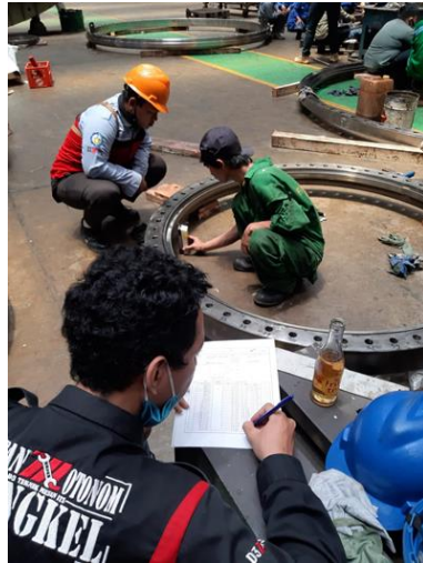
Proses Pengukuran Kekasaran dan Pencatatan Hasil Pengukuran Kekasaran Permukaan MRB
