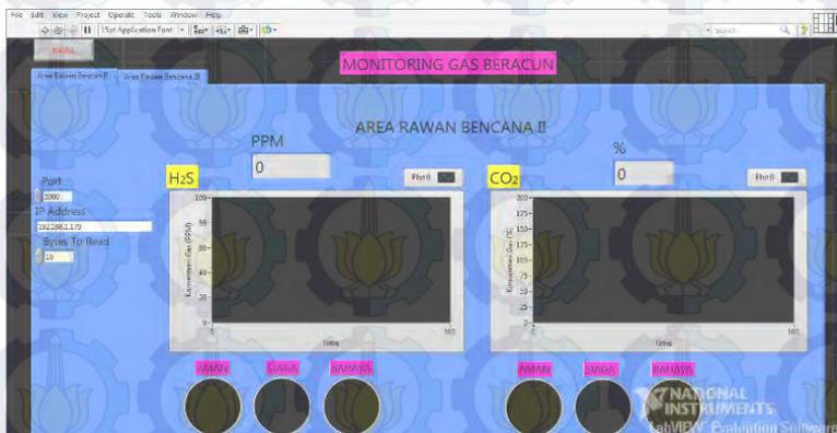
Gambar 4.17. Input Port dan IP address dari arduino di LabVIEW
