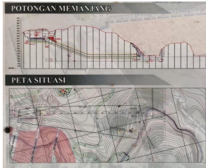
Gambar 2.5 Potongan Memanjang dan Peta Situasi Pelimpah Bendungan (sumber: Kementerian PUPR, BWS Bali-Penida)
