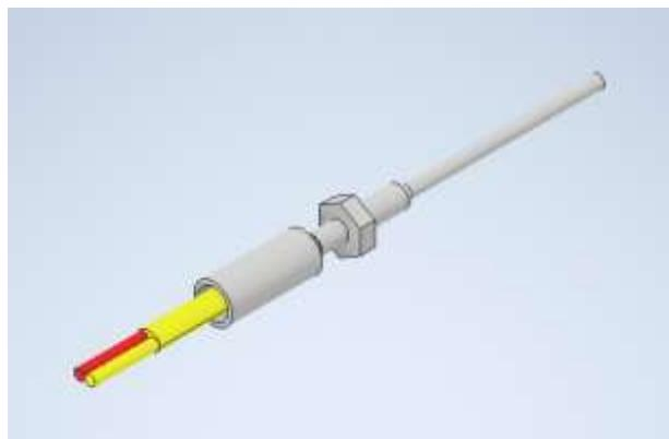
Gambar 3. 7. *Thermocouple sensor*. ( Dokumen pribadi ).
