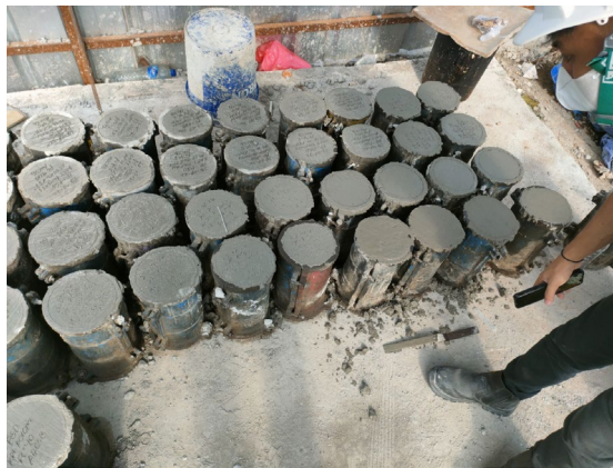
Gambar 5.28 Sample Uji Beton dari Mixer Truck
