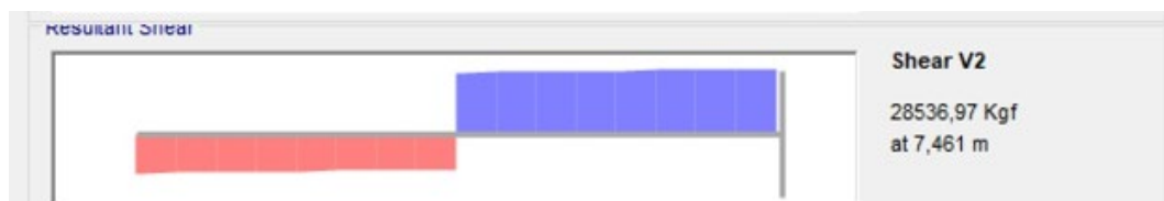
Gambar 5.9 Gaya Geser yang Terjadi pada Balok B2-1
