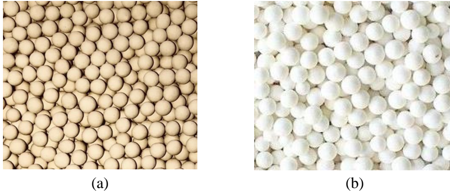
Gambar 4.3 (a). Molecular Sieve dan (b). Alumina Gel pada M.S. Adsorber (Sumber: Adsorbents, 2020 )
