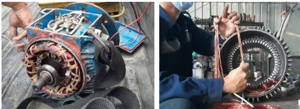
Gambar 4.76 Proses rewinding pada motor 3 fasa
