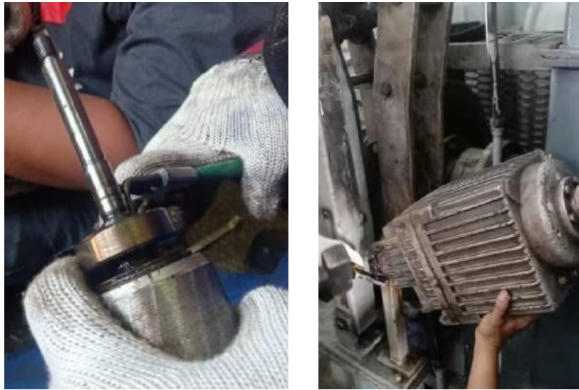
Gambar 4.74 Penggantian seal pada thruster brake
