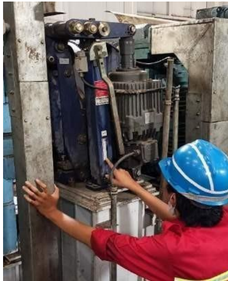
Gambar 4.79 Pengecekan oil level pada thruster brake
