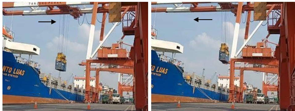
Gambar 4.41 Gerakan trolley pada pada CC 05
