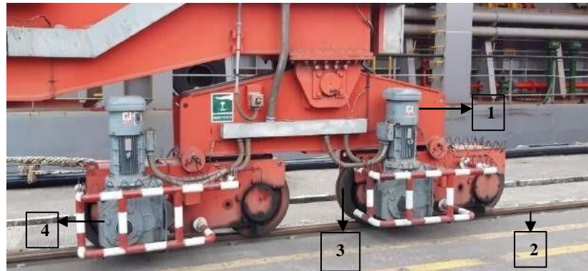
Gambar 4.37 Mekanisme Gantry pada CC 05
