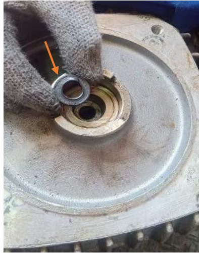
Gambar 4.70 Penggantian seal pada thruster brake
