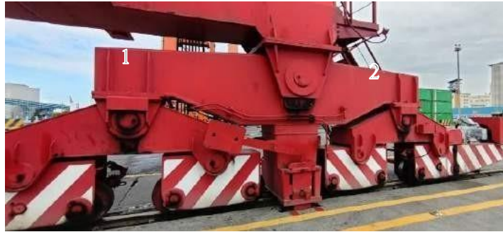
Gambar 4.35 Bogie pada CC 05
