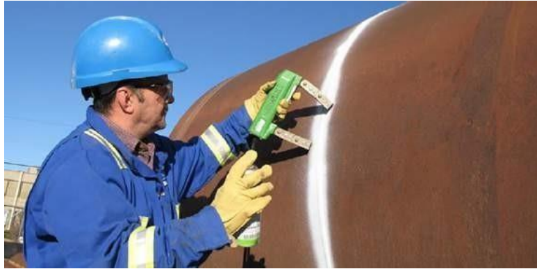
Gambar 4.53 NDT menggunakan metode Eddy Current
