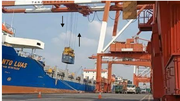
Gambar 4.38 Gerakan hoist pada CC 05
