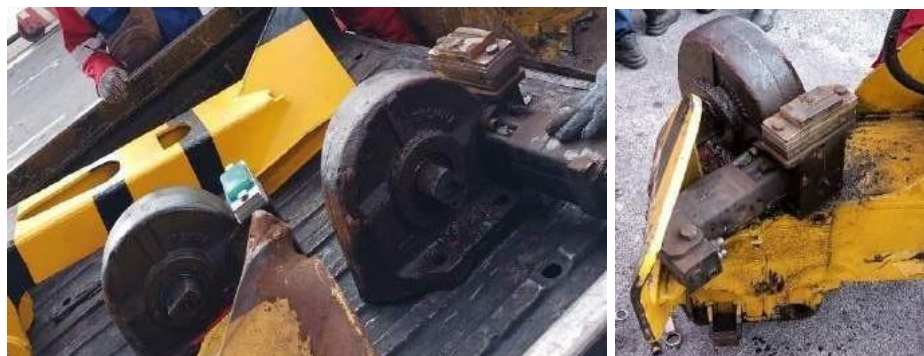
Gambar 4.55 Kegiatan Reactive maintenance pada flipper
