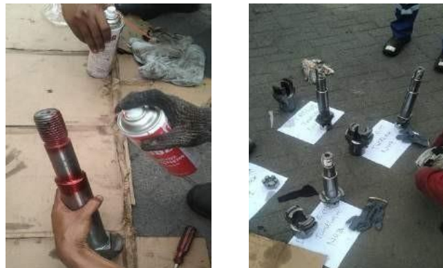
Gambar 4.54 Proses DPT pada twistlock RTG
