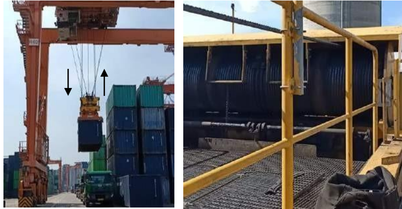
Gambar 4.12 Gerakan hoist pada RTG (Sumber : Dokumen Pribadi)
