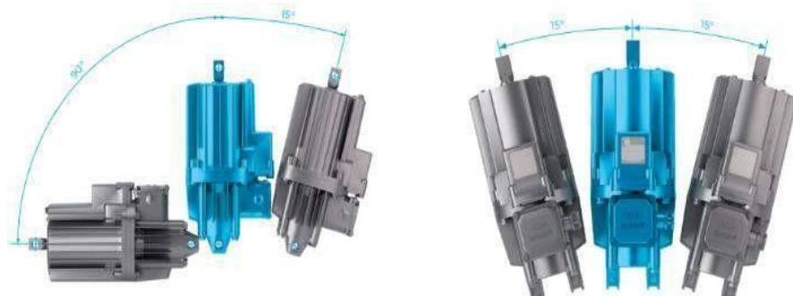
Gambar 4.73 Posisi instalasi yang benar pada thruster brake
